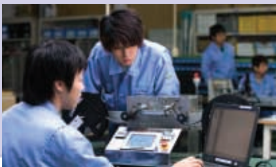
テープ内に収納された電子部品などの数量を確認することができる「パッケージカウンター」の最終調整の様子。
