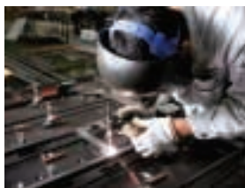
治具の溶接作業の様子
