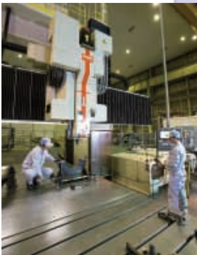
液晶パネルや太陽光パネルを製作するための製造装置を加工する大型五面加工機。(X3500 Y9750 H4000)
