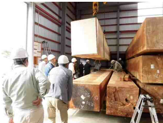
一次製材後の木材検査の様子
