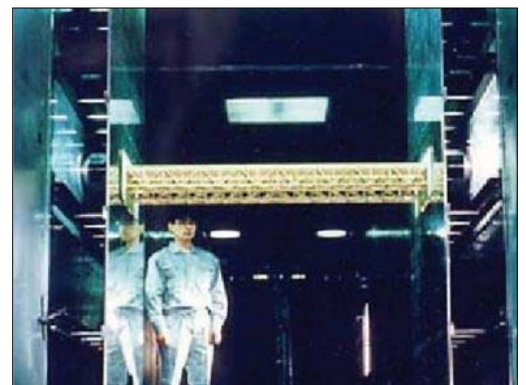
写真 4-5 部分模型による風洞実験
