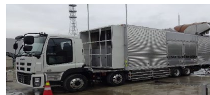
ガスタービン発電機車
