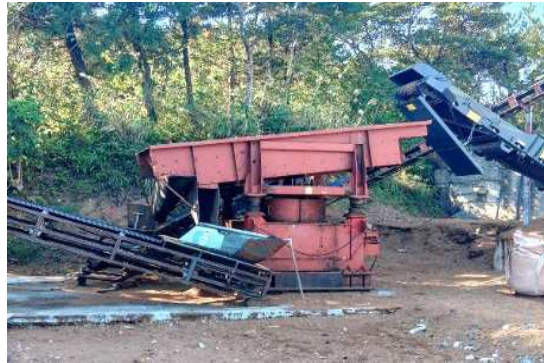
スイングスクリーン スクリーンの旋回運動で選別
