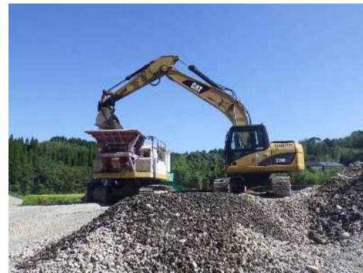
⑤破碎機に投入して破碎 三菱製MRC36JV型
