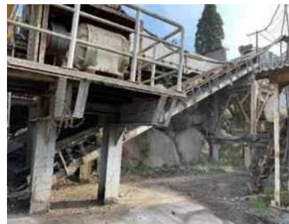
⑦第1ベルトコンベアー ・第一クラッシャーでの破碎後 ベルトコンベアで第2クラッシャーへ
