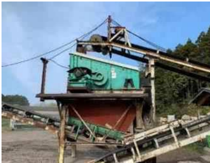
⑪ 振動ふるい機で選別 ・ふるい機で粒度選別 ・30mmスクリーンを通過したものがRC-30 ・オーバーサイズはクラッシャーへリターン
