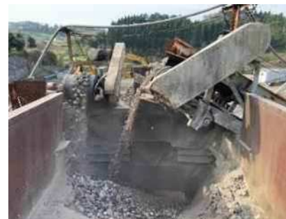
⑧第2クラッシャー ・寿工業製ジョークラッシャー ・ベルトコンベアで第1クラッシャー後の塊を 第2クラッシャーに投入
