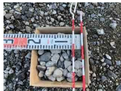
⑯ 製品 ・RC-30 配合割合 がれき類 (Co50% As30%) 新材20%
