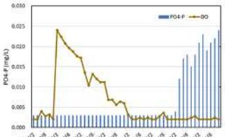
池田湖では、2018年以降全層循環が確認されておらず、底層の貧酸素化に伴うNO<sub>3</sub>-Nの減少やNH<sub>4</sub>-Nの増加、湖底からのPO<sub>4</sub>-Pの溶出、H<sub>2</sub>Sの発生が確認されている。
