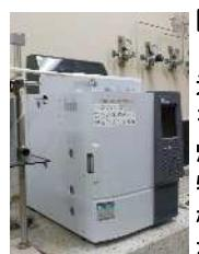
【炎光度検出器】リン、硫黄などの元素を含む化合物を、水素炎中で燃焼させて発生する特有の波長の光を検出する選択性の高い検出器
