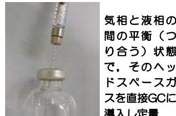
気相と液相の間の平衡（つり合う）状態で、そのヘッドスペースガスを直接GCに導入し定量
