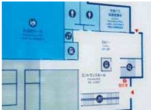
目の不自由な方にも配慮し、各階に点字案内板を設置
