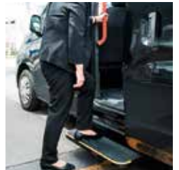
乗降時の負担を軽減する電動式スライドステップと大型手すり (NV200)
