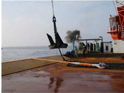
写 8.7.1 アンカー吊り出し
