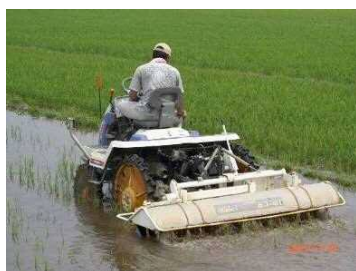
乗用田車による除草作業(8畦同時に行う事が出来る)
