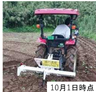
サブソイラによる耕盤破碎
