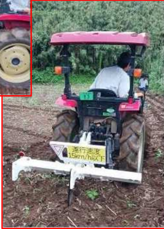
トラクタの22馬力と小さいので 2本爪を1本爪に変更
