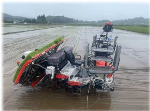
ロボット田植機による可変施肥田植え実証
