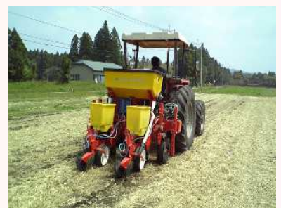
飼料用トウモロコシ不耕起栽培 「不耕起播種機」
