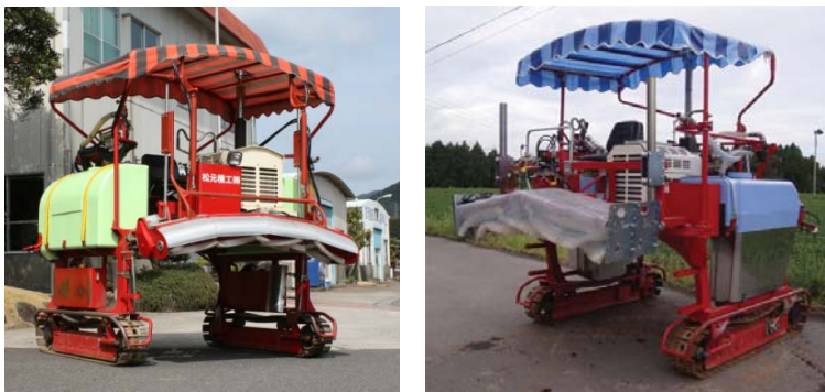
図 1 ブラシを装着した摘採前洗浄機
