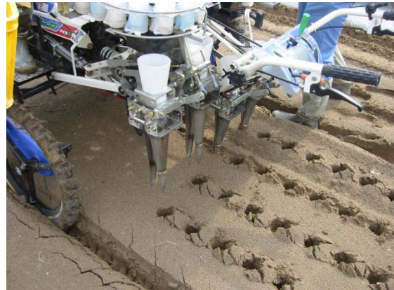
図2 植付状況 標準作式 畦幅120~130cm 条間24cm 4条 株間10~15cm
