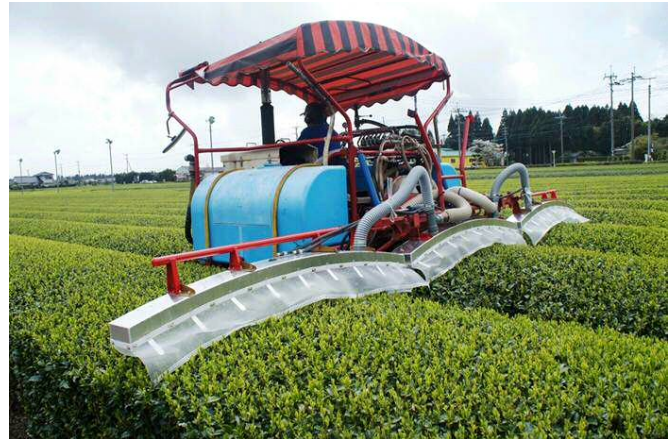
図2 慣行防除機にアタッチ装着した様子
