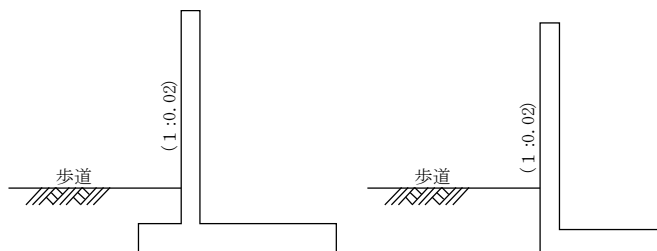
図 8-16 逆 T 型、L 型擁壁の形状
