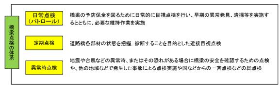
図ー橋梁点検の体系図
