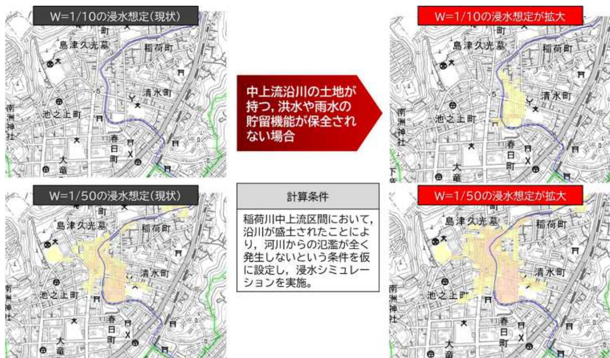
図43 水田の貯留機能保全による下流への負荷軽減効果の例
