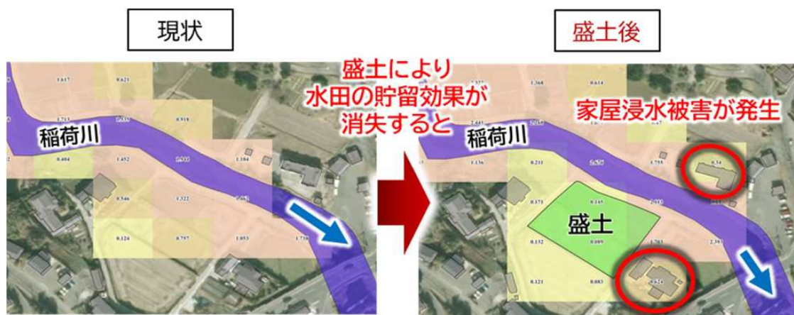
図42 水田への盛土に伴う氾濫形態の変化の例 ( W=1/10 でのシミュレーション結果)
