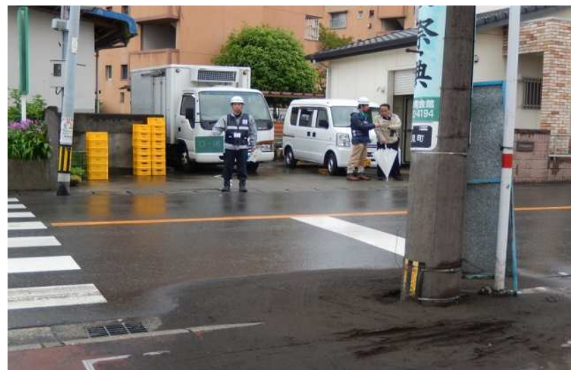
液状化により宅地地盤が沈下
