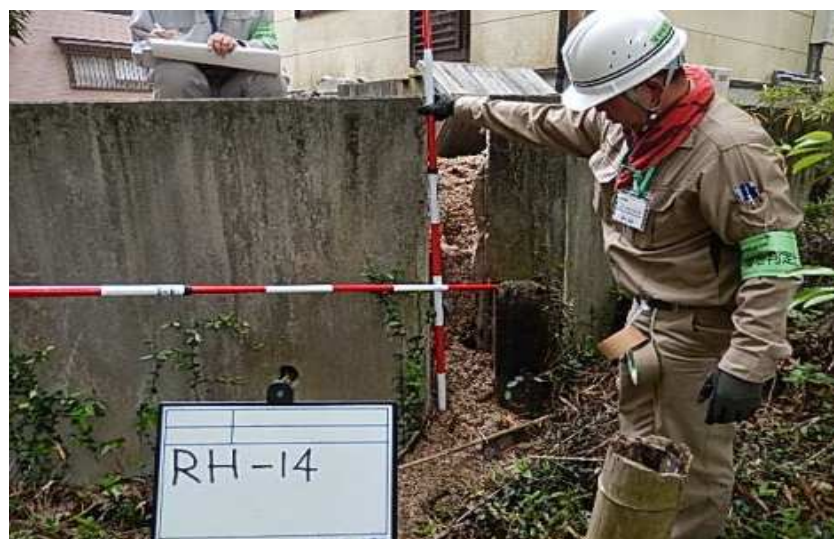
水平移動したL型擁壁の移動距離を測定（危険判定）
