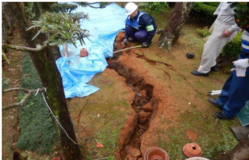
水平移動したL型擁壁の移動距離を測定（危険判定）
