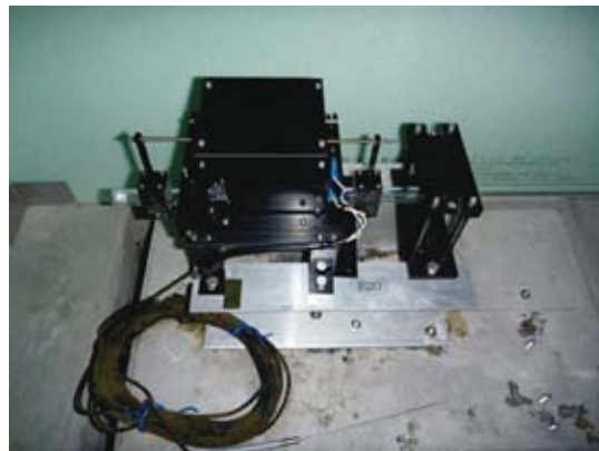
【伸縮計主計測部（有村坑道内）】
