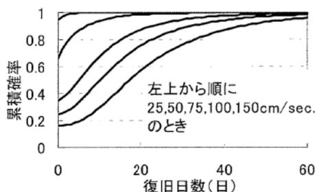
図 5.2-2 下水道の供給率復旧曲線<sup>18</sup>
