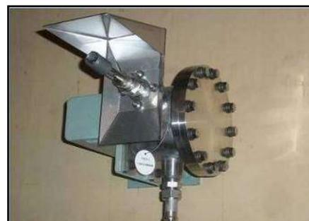
電気式水素燃焼装置
