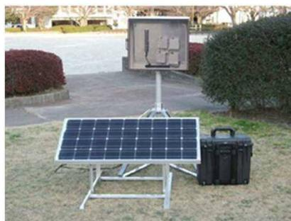
GPS追従型線量率測定装置
