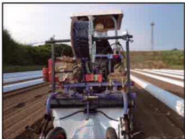
写真1 点滴チューブ設置風景
