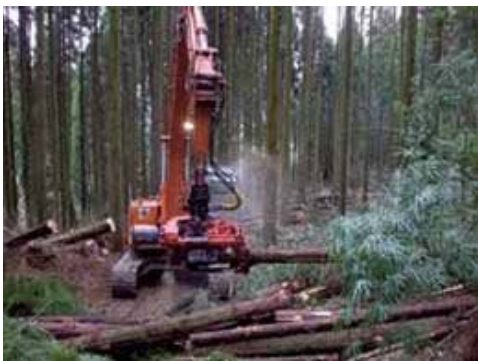
高性能林業機械(プロセッサ)による間伐状況
