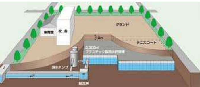
雨水貯留施設
