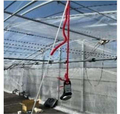
温度ロガーによる温度ムラ測定
