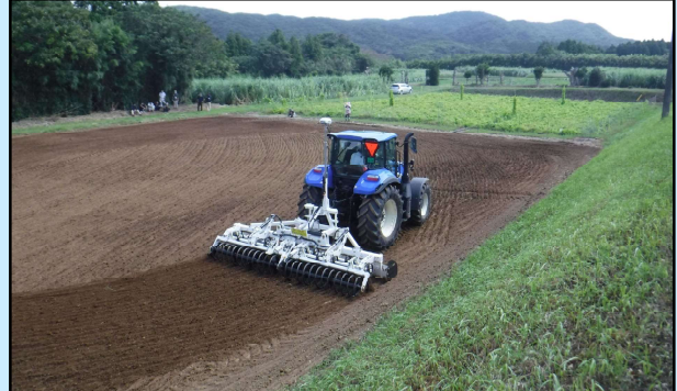
GPSレベラーによるほ場整備の試験
