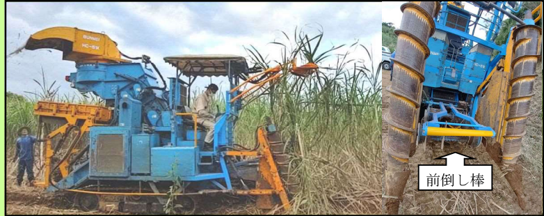
茎数の多い「はるのおうぎ」収穫に対応したハーベスタ（試験機）
