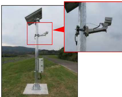
簡易型河川監視カメラ
