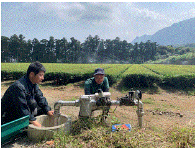
散水時間・間断散水の設定
