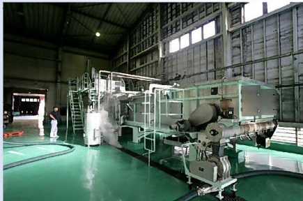
以超大型的連續蒸米機蒸製白米
