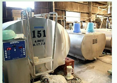
使用於冷卻用的超農用牛乳冷卻機
