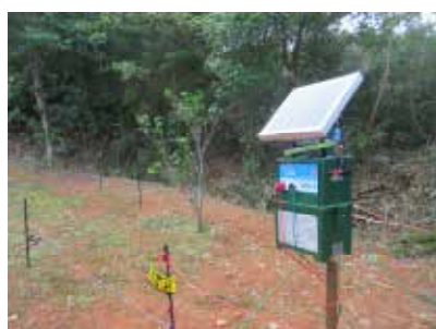
ソーラパネルを太陽光が しっかりと当たる方に向ける
