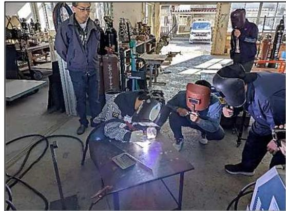
図10 校内実技指導：TIG溶接
