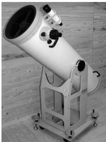
図2. 経緯台付反射望遠鏡
