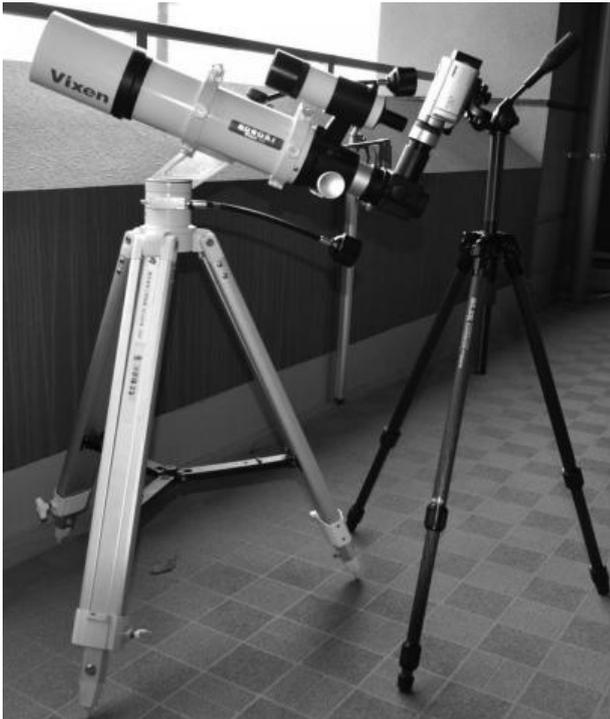
図4. 惑星動画を撮影するための経緯台付屈折望遠鏡（天頂プリズム付き）とビデオカメラ，三脚
