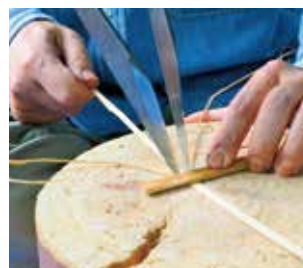
竹ひごの幅をそろえている様子。作品を美しく仕上げるための欠かせない作業の一つ
