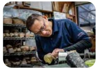
やわらかい素材の錫をミクロ単位で削る。桜島の溶岩のようなゴツゴツした質感にこだわって仕上げる。
