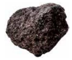
虹色の素となる桜島の溶岩。機械加工し真空状態で高電圧を加えると、溶岩の微粒子が弾き出され、コーティング膜となる。
