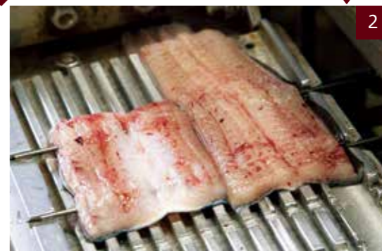
串打ち機で皮と身の間に正確に串が打たれる
