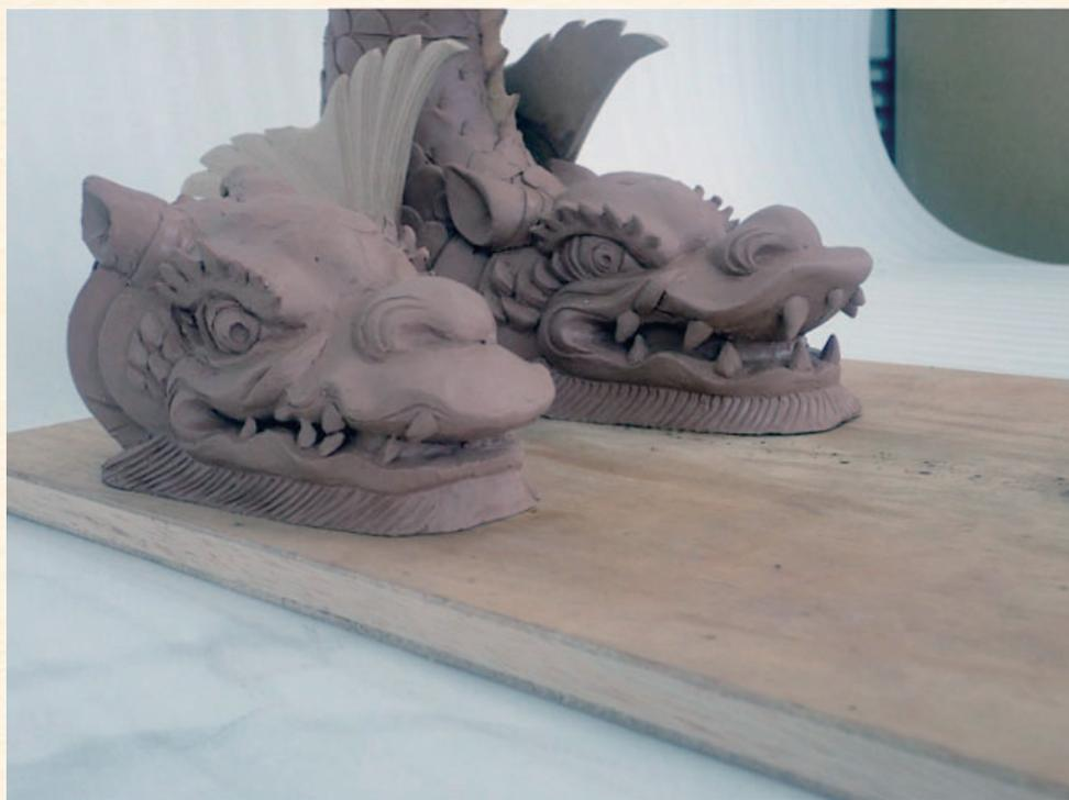
今回製作した型を元に、実際の大きさの金型を作り、鑄造します。
