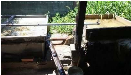
3 甌の蒸気を冷やし、樟脳と樟脳油を分離する
