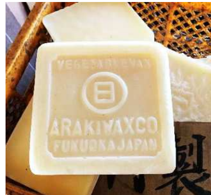
6 溶解して不純物を除去後、型で成形し白蠟が完成（写真は海外向け）
