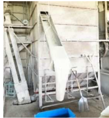
2 分離機で実と房に分け、実を粉碎する
