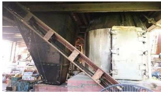
2 右の甌にチップを入れ、左の竈で火を焚き蒸留する
