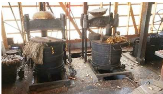
5 圧搾機で樟脳と樟脳油を完全に分離し、樟脳を取り出す
