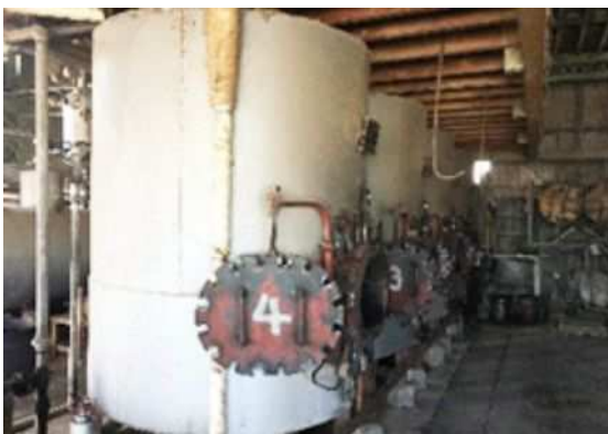
3 溶剤を混ぜて蠟を抽出し、更に溶剤と蠟を分離する
