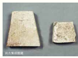
石橋の石組み技術(西田橋) 薩摩焼の技術(耐火レンガ) 反射炉で使用した耐火レンガの製造には、もともとあった薩摩焼の技術が取り入れられ、また、在来の石組み技術を活かして反射炉が組み上げられた。
