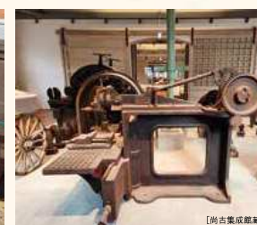
1863年オランダ製の形削盤(かたけずりばん)
