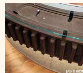
工場の動力には蒸気機関が用いられた。形削盤など場内の機械に動力を伝えていた歯車(フライホイール)が受付カウンターとして利用されている。
