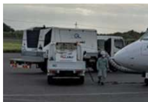
【奥】エアスターター車 【手前】電源車
