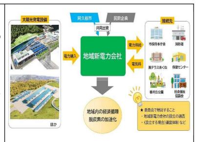
・市役所と番所丘公園に太陽光発電施設を設置し、市役所をはじめとした6つの施設を自営線でつなぐことで、二酸化炭素の排出量を削減するとともに、平常時における給電と災害時の大規模停電に備える防災力の向上を図る。
