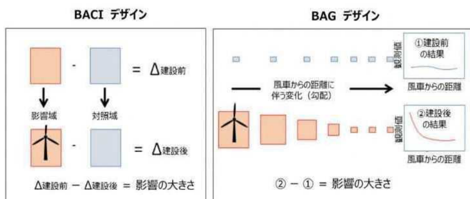
図3. 風車等の設置位置からの距離に伴う変化の調査結果から影響の大きさを求めるモニタリング調査方法のイメージ図（Secor, 20185 を一部改変）。
