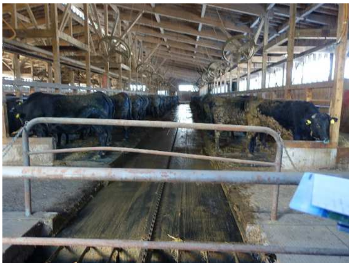
牛舎内のバースクレイバー方式による原料運搬①
