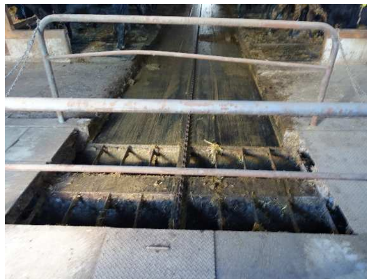
牛舎内のバースクレイバー方式による原料運搬②
