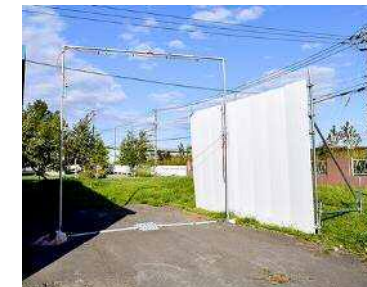
写真 車両自動消毒装置(北海バネ)
